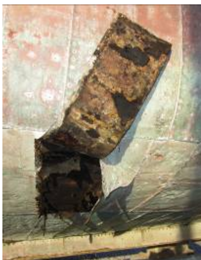
T.v. og midt. Midtskibs under isforhudningen. T.h. Køl, spanter og klædning er i god stand.
