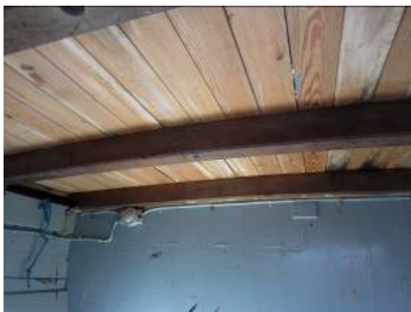
T.v. dækket set nedefra lastrum. T.h. planker under isforhudningen over vandlinjen.
