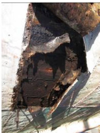
T.v. og midt. Midtskibs under isforhudningen. T.h. Køl, spanter og klædning er i god stand.
